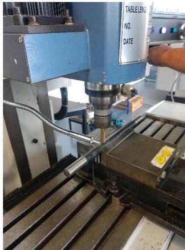
**Figura 29.** Fresado de ejes de caja de cuchillas.
