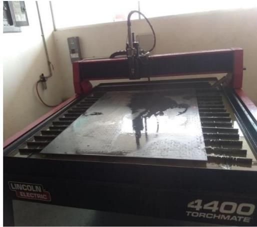
**Figura 28.** Corte de lámina por plasma para armado de la caja de cuchillas.
