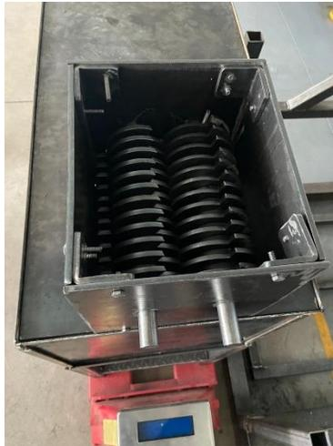
**Figura 31.** Vista superior interna de caja de cuchillas.
