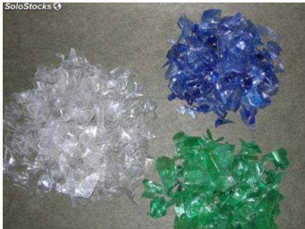
**Figura 12.** Ejemplo del resultado obtenido al utilizar una máquina trituradora con plástico PET [17].
