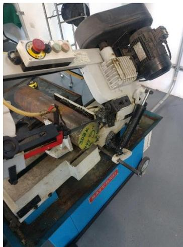
**Figura 30.** Corte de oblea por sierra cinta para manufactura de cuchillas preliminares.
