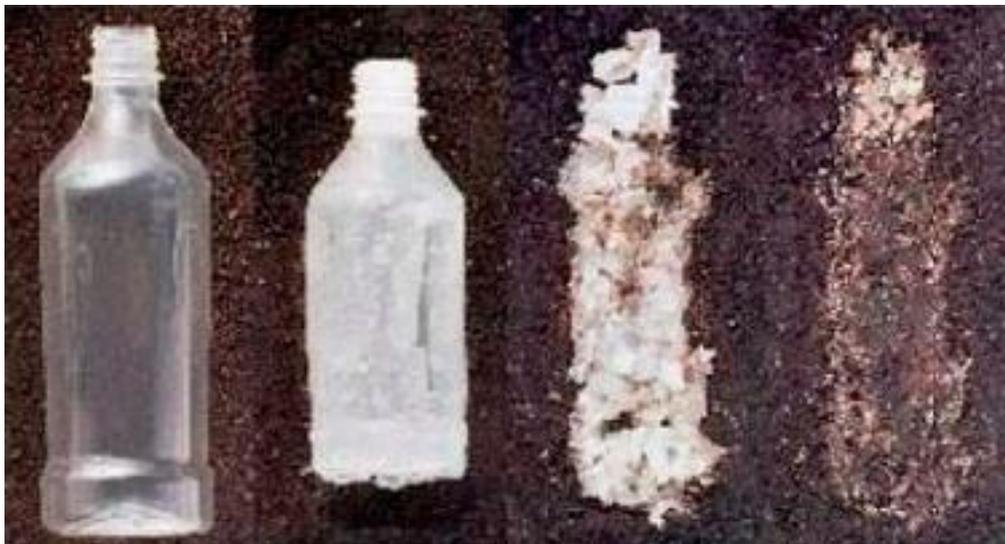
**Figura 3.** Ejemplo de proceso de biodegradación de plástico tipo PET [3].
