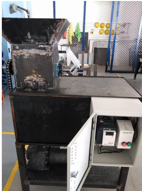
**Figura 32.** Gabinete de control de variador del sistema de transmisión de potencia montado en estructura de soporte
