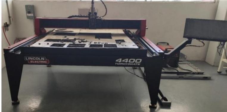
**Figura 14.** Máquina de plasma LINCOLN ELECTRIC 4400.
